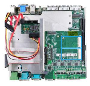
mini-PCle slot on MezIO<sup>™</sup> module
